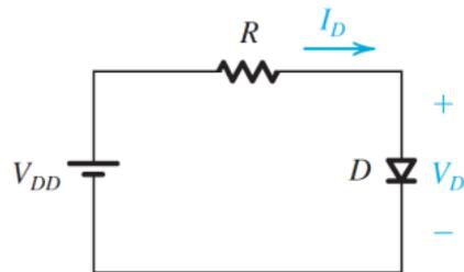
**FIG 1.** A simple diode circuit
